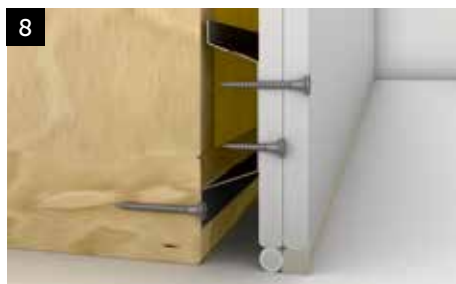
8 Akustikprofilen närmast golvet monteras så att den kan skruvas till syllen. Gipsskivorna monteras med ett avstånd på minst 10 mm till golvet. Spalten tätas med elastisk fogmassa, sockellist bör limmas mot gipsskivorna. Om gipsskivorna ställs mot golvet kommer profilen att pressas mot reglarna och ljudisoleringen försämras kraftigt.
