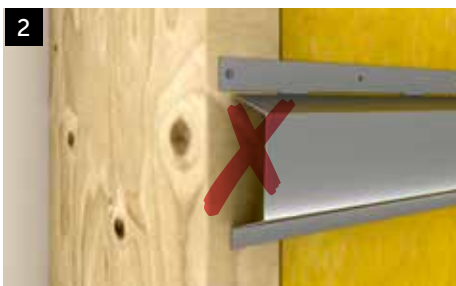
2 Om profilen skruvas i ovankant riskerar den att pressas mot reglarna när gipsskivan monteras vilket ger kraftigt försämrad ljudisolering.
